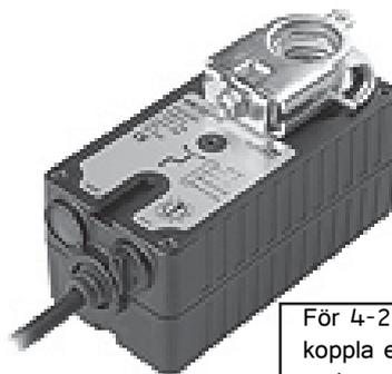
För 4-20mA styrsignal koppla ett 500ohms resistor över 2-10Vdc styrsignal
